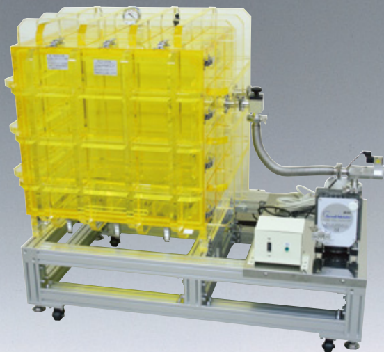
大型真空デシケーター(紫外線カット仕様 外寸: W1200×D700×H1102mm)
