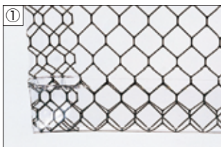
① 折り返し 切断部補強のため、折り返してウェルダー溶着。
