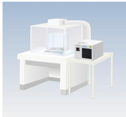
電子天秤は高い測定精度で質量を測定します。温湿度の変化によって測定物の質量が変わると一定の評価ができないため、精密な温湿度管理により微妙な変化を防止し、測定の再現性を向上させます。
