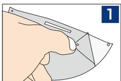
1 シールドの両面に貼られているフィルムを剥がします。
