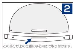
2 図の向きを参照にして、フレーム部分とシールドを装着します。
